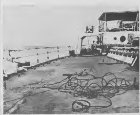
AFTERDECK of the freighter Liana shows raling damaged when a thirty-ton piece of equipment smashed overboard in heavy seas. DEK PATRAS di e bapor di carga Liana ta muntra donja cu e result na e raling ora un carga di trinta ton a cai over di bordo den lamar rabioso.
